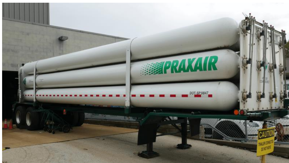
Figura 34 - Tube-trailer para H 2 (200 bar, capacidade aprox.: 22 m 3 ) (Linde, 2022)
