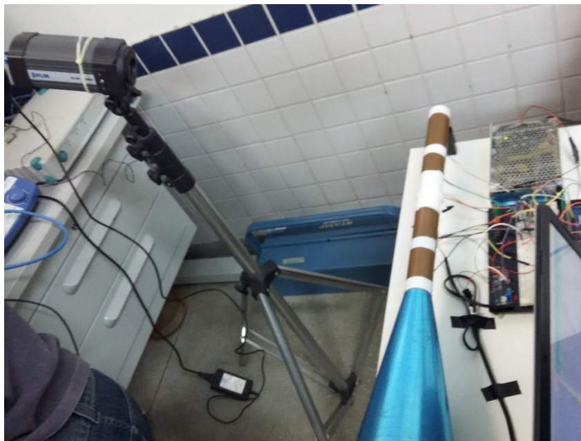
Figura 37: Bancada de testes termográficos
