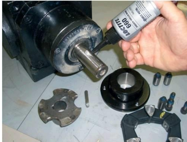
Figura 14: Aplicação do LOCTITE 660 (Henkel)
