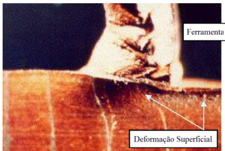
Figura 27 - Deformação plástica na usinagem Fonte: Astakhov (2011).
