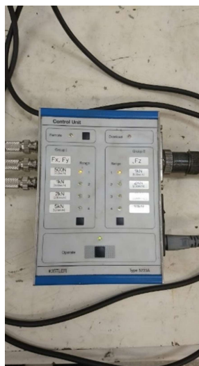
Figura 47 - Condicionador de sinais Kistler modelo 5233 A Fonte: Autor
