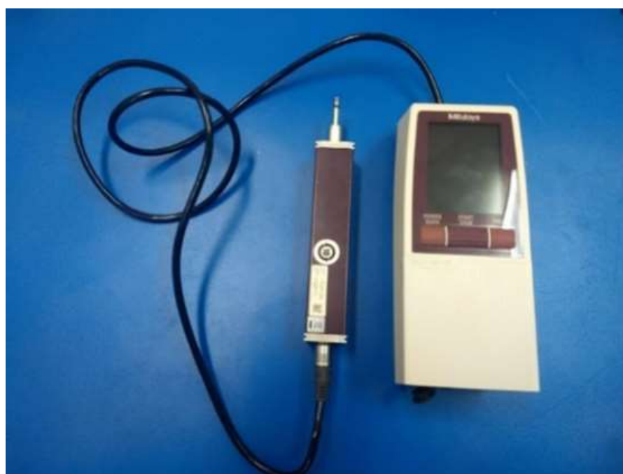
Figura 492 - Rugosímetro Mitutoyo modelo SJ-210P Fonte: Autor
