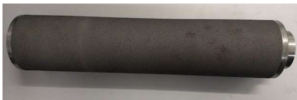
Figura 35 – Fotografia do corpo de prova com substrato de aço SAE1020 aspergido termicamente Fonte: Autor
