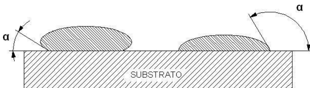
Figura 10 - Esquema de partículas aspergidas fazendo analogia com a tensão superficial de fluidos. Fonte: Cortés (1998).
