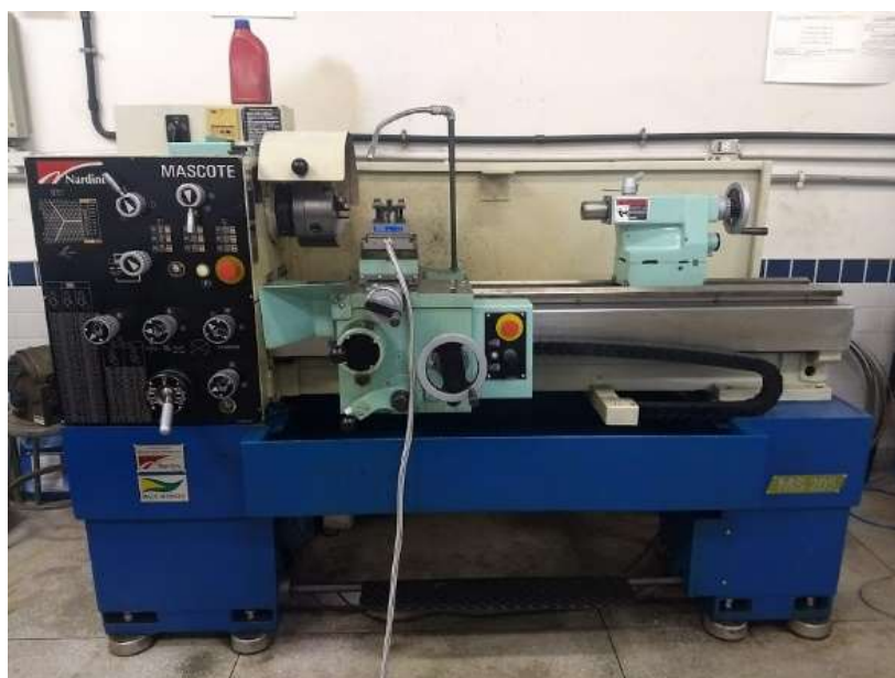
Figura 44 - Torno MS 205 da Indústrias Nardini S/A.
