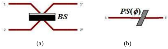
Fig. 1: Dispositivo ópticos: (a) divisor de feixes balanceado (BS) e (b) deslocador de fase (PS).
