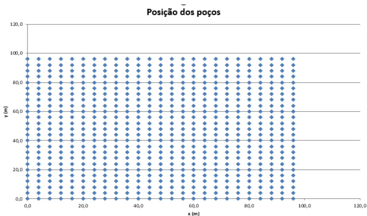
Figura 15 - Posição dos poços Fonte: Autor
