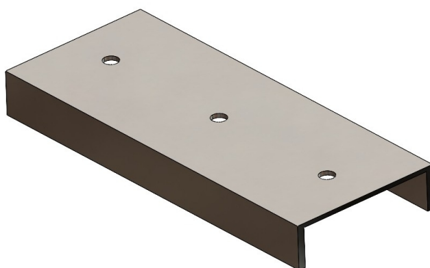
Figura 23 - Viga em 'U' com furos.
