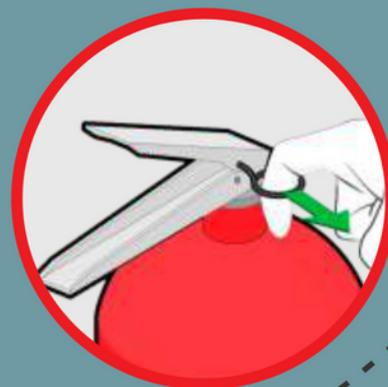
Após selecionar o extintor adequado, retire o pino de segurança rompendo com o lacre. Faça um teste para verificar se está funcionando.
